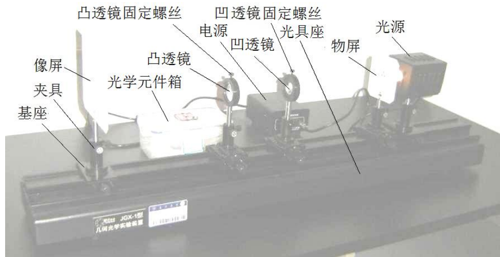
图 7 透镜焦距测量的实验装置
