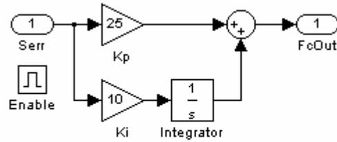
b PI Controller 子系统结构图
