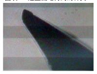
断。此时将电源及时切断,就可以得到不错 图表 3 通直流电得到的针尖(高倍)的针尖了。
