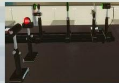
显微镜搭建与放大率测量
